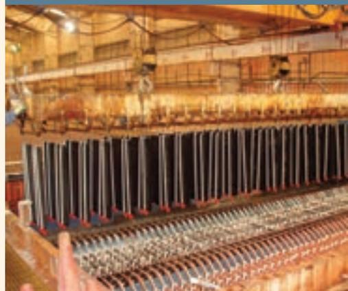
*La instalación de ánodos alternativos en el proceso de extracción por solventes y electro-obtención (en inglés, SX/EW) en la Chino Mines Company en Nuevo México. El uso de ánodos alternativos es una tecnología que puede reducir la energía consumida en el proceso SX/EW en un 15 por ciento.*
