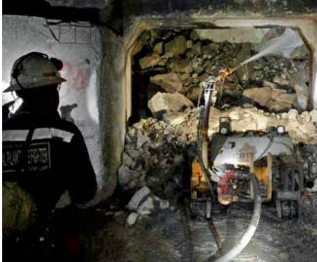
PTFI está desarrollando y utilizando controles críticos mejorados, incluyendo cañones de agua para mover eficazmente grandes rocas que pueden obstruir los puntos de extracción de mineral mientras el operador mantiene una distancia segura.
