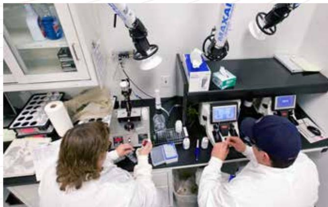
Cientos de muestras de aceite usado son analizadas diariamente en el Laboratorio y Centro de Confianza de Análisis de Aceite. Los técnicos preparan muestras para un instrumento ferrógrafo analítico, que separa las partículas de desgaste y contaminantes de las muestras fluidas que pueden ayudar a los mecánicos a mantener maquinaria de alta eficiencia.
